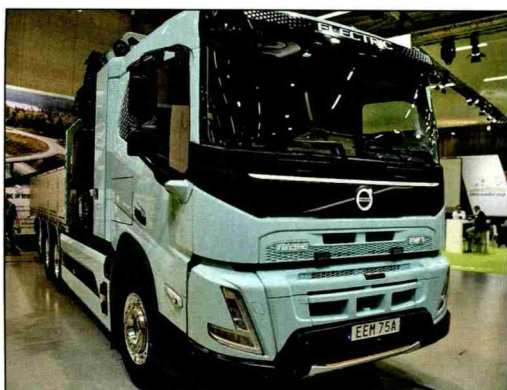
Première suisse pour le Volvo FMX Electric dont les trois moteurs électriques développent 666 chevaux.
