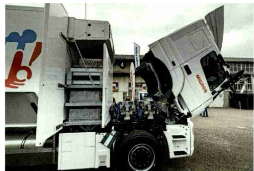
Wasserstoff-LKW aus der Schweiz – das Projekt der Migros Genf auf Kamaz-Chassis wird von der ETH Lausanne und der Larag mitgetragen.
