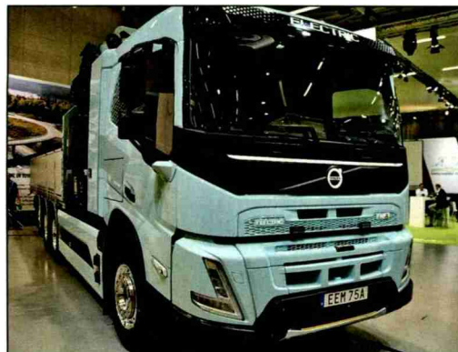
Volvo FMX Electric: Auch er feierte Schweizer Premiere. Ihn treiben drei E-Motoren an.
