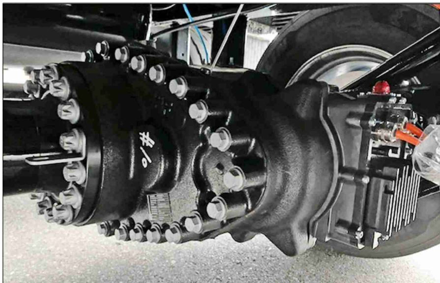
L'essieu de la remorque frigorifique produit de l'électricité par récupération.
