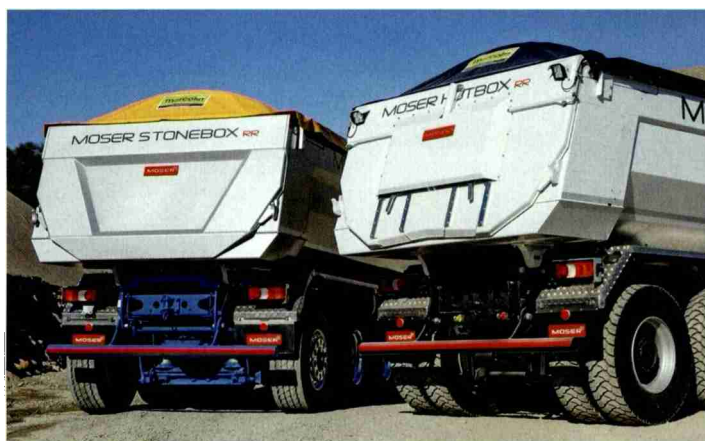
Links ein hydraulisch hochschwenkbarer Rückladen RLHH, rechts ein RLHH 2+ mit Doppelschiebersystem.
