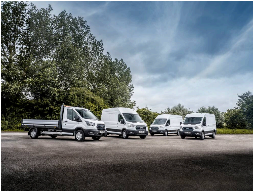
Drei Radstände, zwei Dachhöhen, nach Bedarf als Kastenwagen mit Einzel- oder Doppelkabine für bis sechs Personen oder als Fahrgestell für diverse Aufbauten ...
