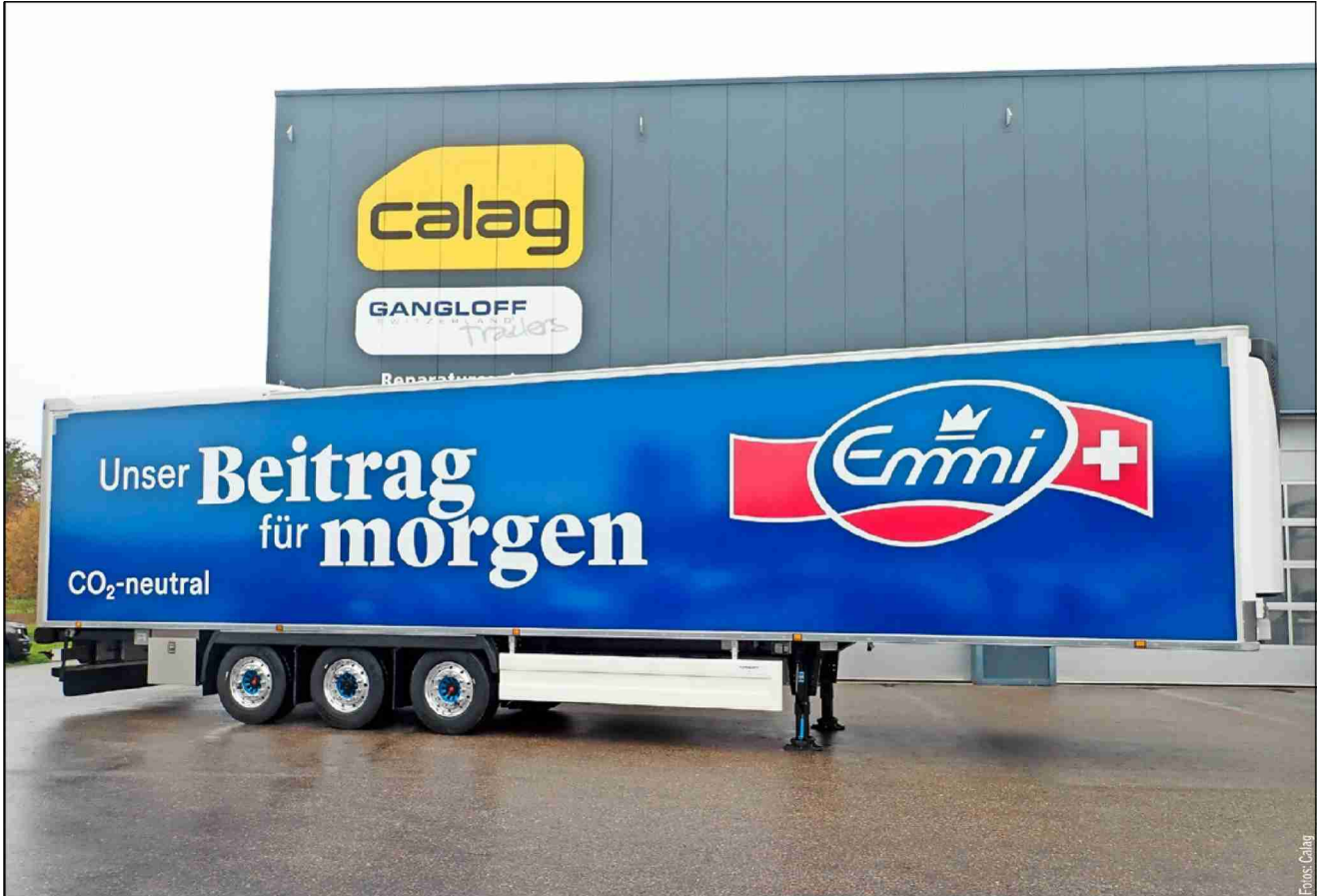
Der neueste Chereau Kùhlsattelaufleger der Firma Emmi verfügt über das autonome Carrier eCool System und ist deshalb äusserst effizient.
