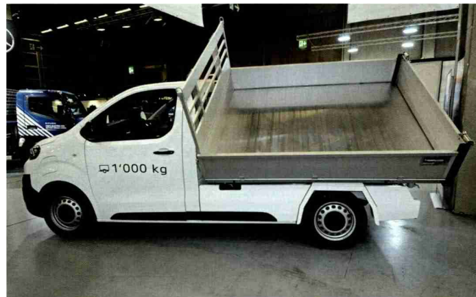
Der Kipper-Umbau auf dem Peugeot e-Expert (Van of the Year 2021) wurde vom Carrosseriewerk Safenwil bewerkstelligt.
