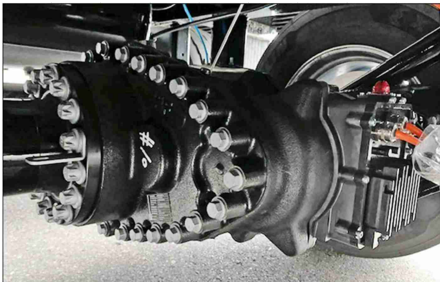
Die Achse des Kühlauflegers produziert den Strom durch Rekuperation.
