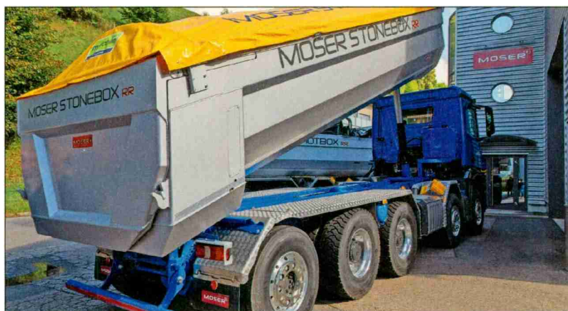
La Stonebox RR à basculement arrière, à charge utile optimisée et à haute résistance.
