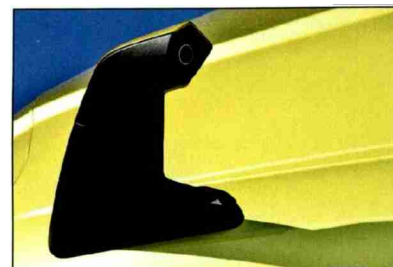
Les caméras du DAF Digital Vision System ont remplacé les rétroviseurs traditionnels.
