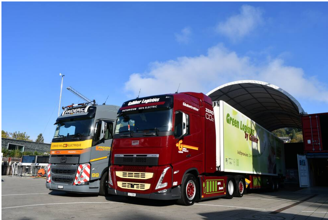
Die 900 kWh grossen Akkus vergrössern im Logistikbereich den Aktionsradius und ermöglichen auch bei Schwertransporten batterieelektrische Antriebe.
