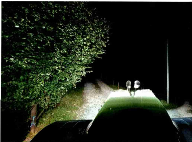
Grossflächige Ausleuchtung mit dem Super-Breitstrahler, einem LED-Arbeitscheinwerfer von Oledone (Artikel WDOB060)
